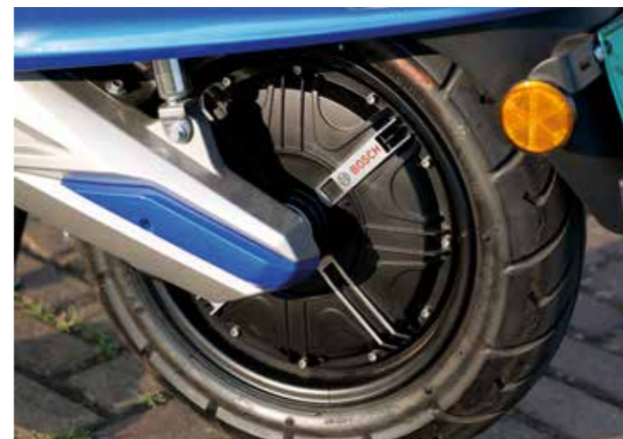
3.000 Watt Bosch naafmotor
